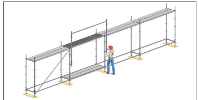
Fig. 37: Utilización de la barandilla de montaje en el modulo de acceso.
