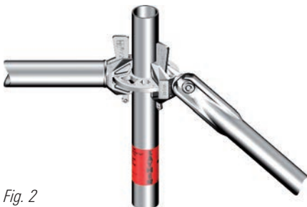
Fig. 1: Allround de acero según Z-8.22-64
