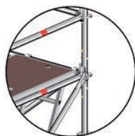
Fig. 84: Unión de verticales con espigas atornilladas
