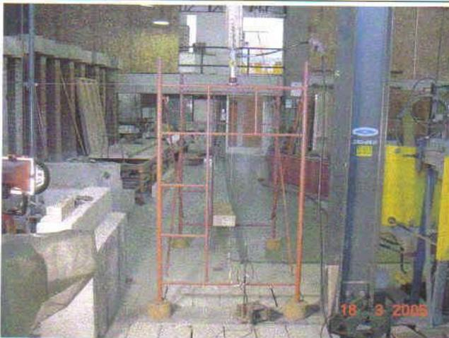
**Fotografía 3: Detalle del ensayo de Carga Vertical a Marco Transversal**
