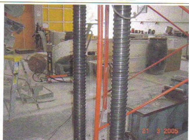
**Fotografía 6: Pie derecho sometido a la carga máxima durante el ensayo de carga vertical.**
